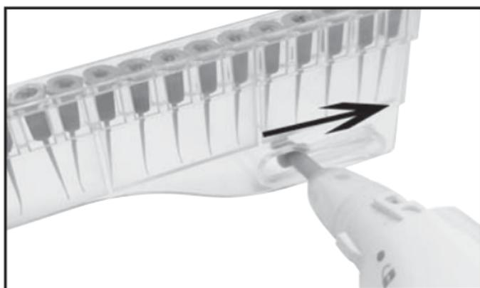
Końcówka czyszcząca ② zostaje zdjęta w ten sposób z trzpienia do elementów nasadzanych ③ i odpada.
