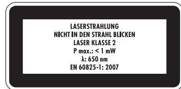
■ Schauen Sie nicht direkt in den Laserstrahl, bzw. in die Öffnung, aus der er austritt.
